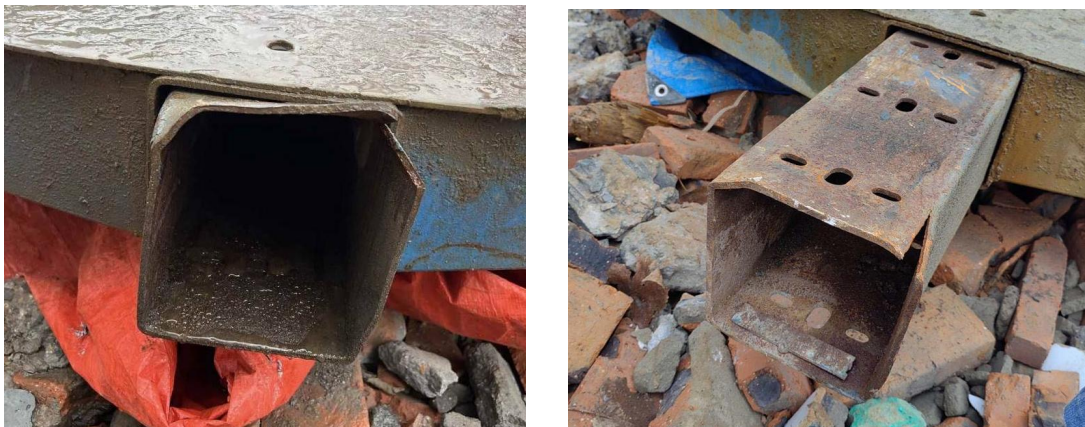
图7 放射梁大方管（160×5mm）上缘撕裂
